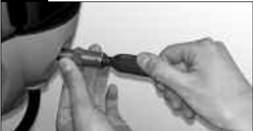
För att starta rengöringsprocessen, medan du håller rengöringsadaptern på plats, skruva loss rengöringspatronen endast 1/4 varv.
