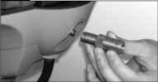
Skruva för hand på rengöringsadaptern på ventilen.
