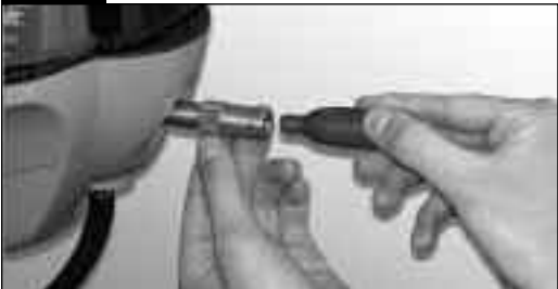
Medan du håller adaptern på plats, skruva in rengöringspatronen i adaptern.
